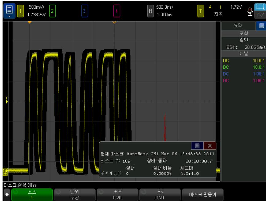
9 마스크를 삭제하고 마스크 테스트를 종료하려면, **Back** 뒤로 / 위로 키를 눌러서 마스크 테스트 메뉴로 복귀한 후 **마스크 삭제** 소프트웨어를 누릅니다.
