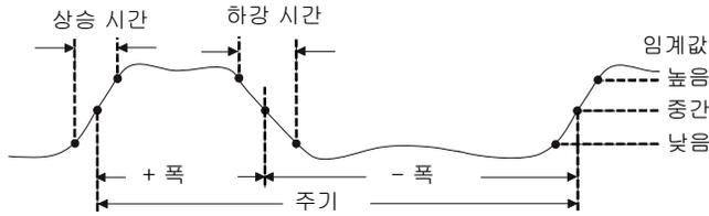
기본 하위, 중간 및 상위 측정 임계값은 최고값과 최저값 사이의 10%, 50%, 90% 입니다. 다른 백분을 임계값과 절대값 임계값 설정에 대한 내용은 “**측정 임계값**” 267 페이지 단원을 참조하십시오.
