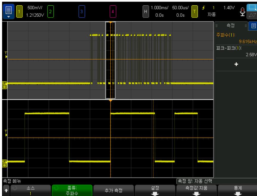
그림 49 주파수 측정을 위한 이벤트 격리
