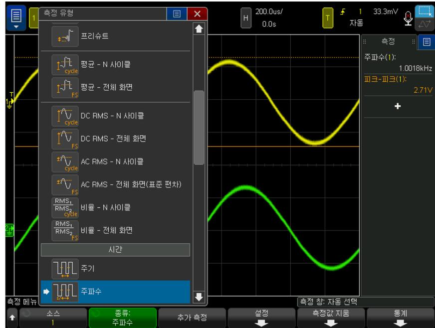
터치스크린을 사용하여 측정을 선택할 수도 있습니다. 측정 사이드 막대 대화 상자의 "+" 를 터치해 측정 유형 메뉴를 열 수 있습니다. "화면의 소프트키 및 메뉴 터치하기" 52 페이지 단원을 참조하십시오.
