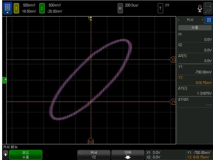
그림 4 위상차 측정, 자동 및 커서 사용
