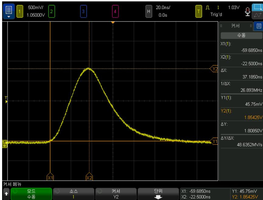
그림 41 중간 임계값 점 이외의 펄스 폭을 측정하는 데 사용되는 커서
