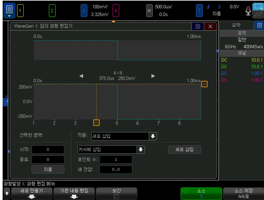
파형 편집 메뉴를 열면 기존의 임의 파형 정의를 볼 수 있습니다. 다이어그램에 표시되는 전압 및 시간 주기는 구속 파라미터로, 파형 발생기 메인 메뉴의 주파수 및 진폭 설정을 따릅니다.
