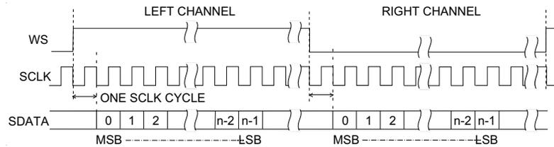
**13SCLK 경사** 소프트웨어를 누른 다음, 엔트리 노브를 돌려 테스트 대상 장치에 클럭으로 적용될 데이터의 SCLK 에지를 선택합니다 (상승 또는 하강 중). 화면의 도표가 사용자 선택에 따라 변경됩니다.
