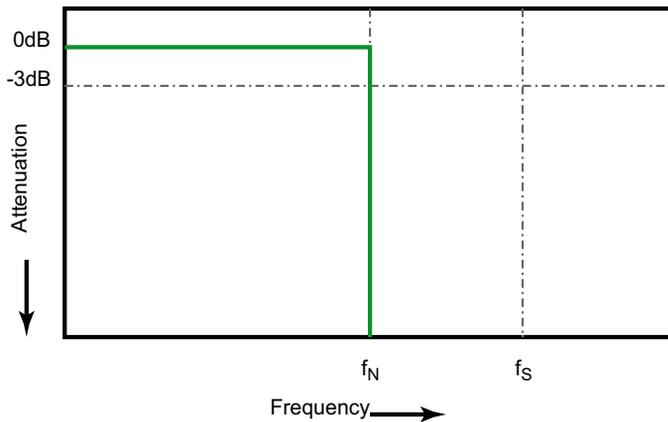
그림 35 이론적인 브릭월 (brick-wall) 주파수 응답
