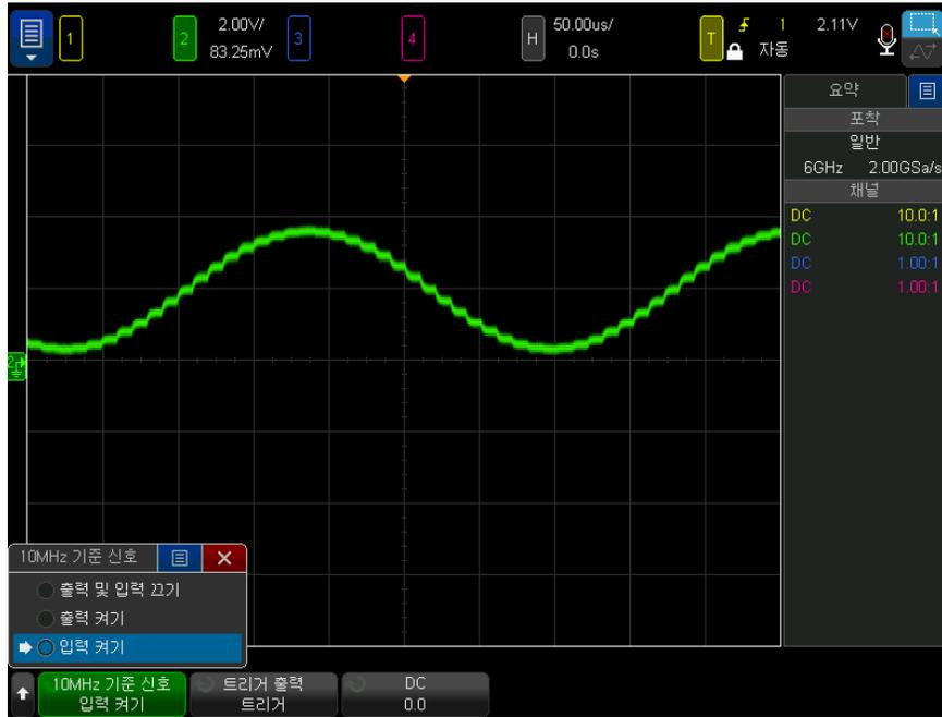
샘플 클럭 신호의 외부 공급이 중단되면 잠김 상태가 풀리게 됩니다. 화면 오른쪽 상단의 잠김 기호는 잠기지 않는 자물쇠 아이콘으로 바뀌고 오실로스코프는 데이터 수집을 중단합니다. 외부 공급 샘플 클럭이 다시 안정화되면 오실로스코프가 샘플링을 재개합니다.
